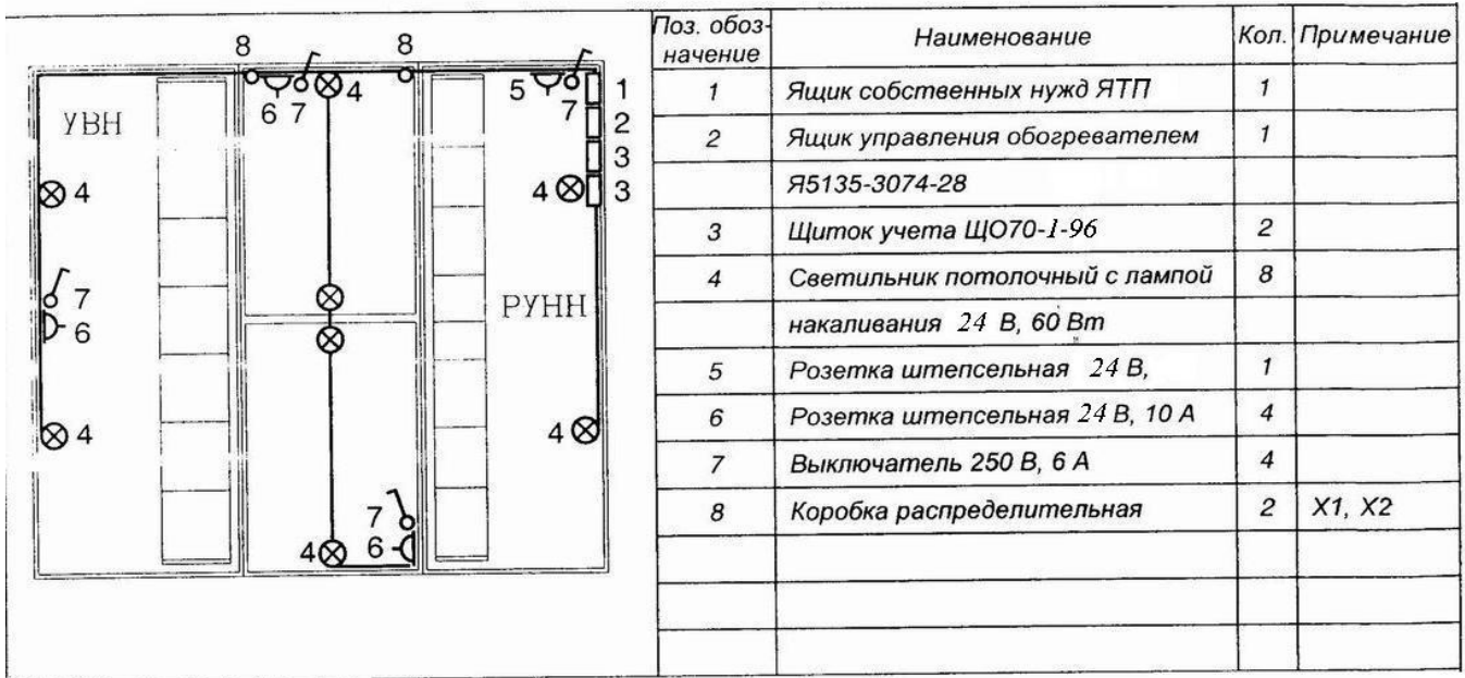
Рисунок 5. Схема электрическая соединений блоков УВН, трансформаторов и РУНН
